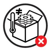
Las piezas tienen que embalarse a temperatura ambiente (ni demasiado calientes ni demasiados fríos) para evitar la formación de condensación. Se aconseja el uso de bolsas desecantes en el interior de los embalajes para evitar cualquier problema de condensación durante el transporte.
