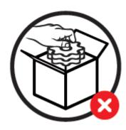
Les pièces à emballer doivent absolument être manipulées avec des gants propres car les traces de transpiration peuvent créer de la corrosion sur la surface du métal.
