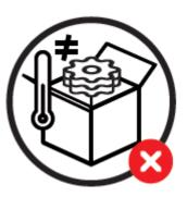
Les pièces à emballer doivent être à la température ambiante (donc ni trop chaudes, ni trop froides) pour éviter la formation de condensation. L'utilisation de sachets déshydratants est conseillée à l'intérieur de l'emballage pour parer à tous problèmes de condensation durant le transport.
