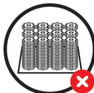
Per la protezione di pezzi sfusi o in imballi di grosso volume, posizionare i diffusori di VCI in aggiunta (formati carta VCI, diffusori Noxy VCI, spugne VCI, ecc.)
