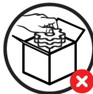
I pezzi da imballare devono assolutamente essere maneggiati con guanti puliti poiché l'acidità della pelle potrebbe provocare della corrosione sulla superficie del metallo.
